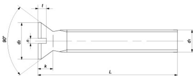
**Винт DIN 963, класс прочности 5.8** — оцинкованный винт с потайной головкой и прямым шлицем применяется в машиностроении, приборостроении, автомобилестроении, мебельной промышленности для соединения деталей машин и механизмов.
