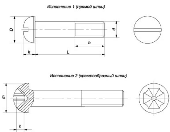
**Винт ГОСТ 17473-80, класс прочности 5.8** — винт с полукруглой головкой применяется в машиностроении, приборостроении, автомобилестроении, мебельной промышленности для соединения деталей машин и механизмов.
